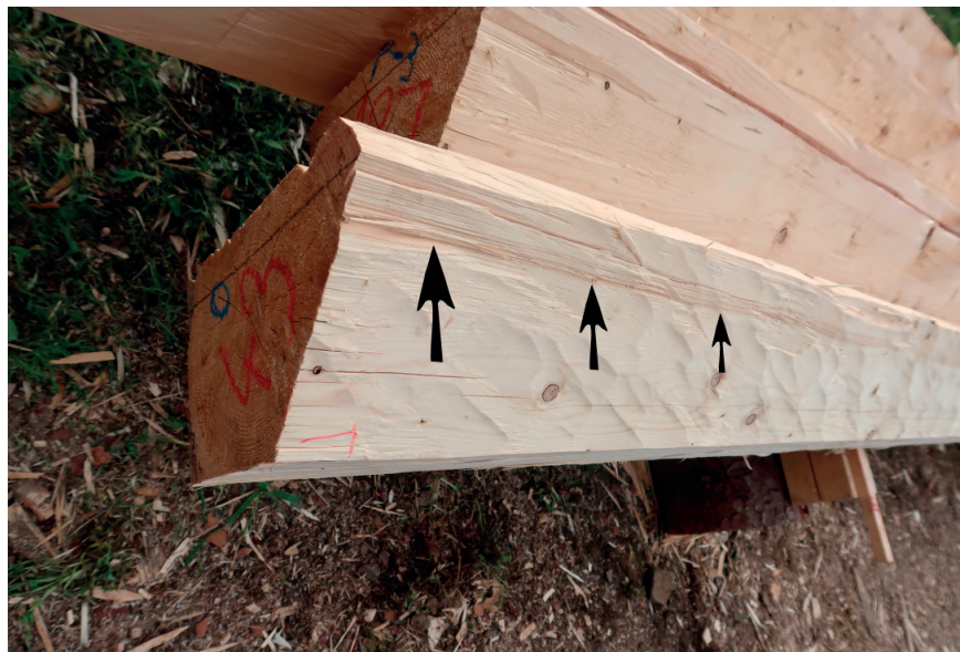
Obr. 3.18: Tlakové dřevo na podélném řezu
