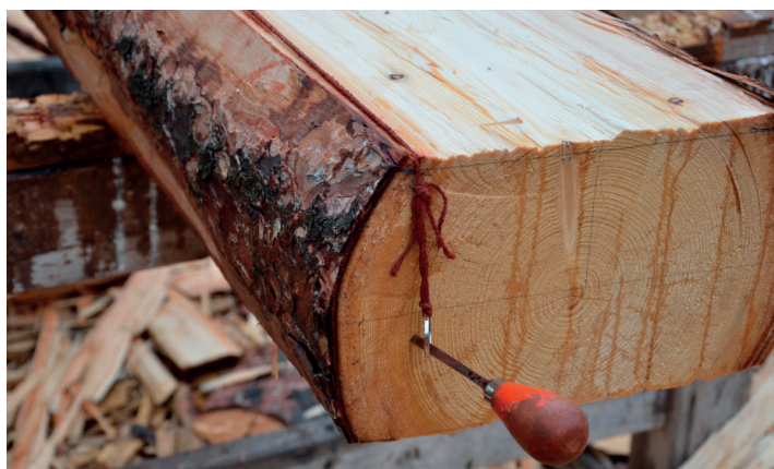
Obr. 5.3.7: Připevnění konce šňůry s kroužkem ke čelu kulatiny
