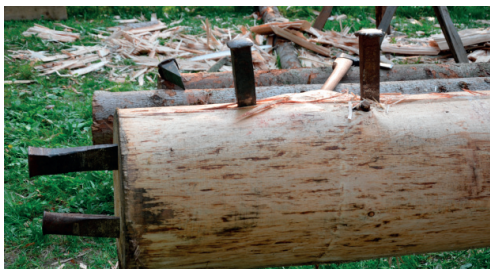
Obr. 5.4.9 Začátek štípání (kovové klíny v čele a na obvodu kulatiny v prvních dvou dlabech)
