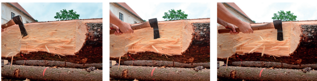
Obr. 5.3.18: Hrubování postupně směrem od sebe a zpět
