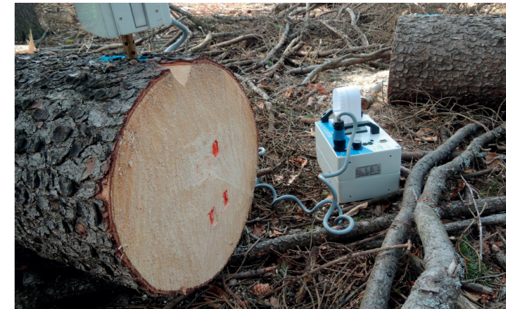
Obr. 3.28: Vrtání kulatiny pomocí přístroje Resistograph
