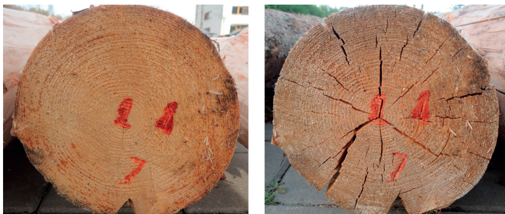
Obr. 4.9: Letní těžba: A – čelo oloupané kulatiny po kácení, B – čelo oloupané kulatiny po 1. roce přirozeného stárnutí
