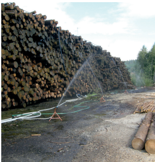
Obr. 4.17: Postřikování smrkové kulatiny na skládce
