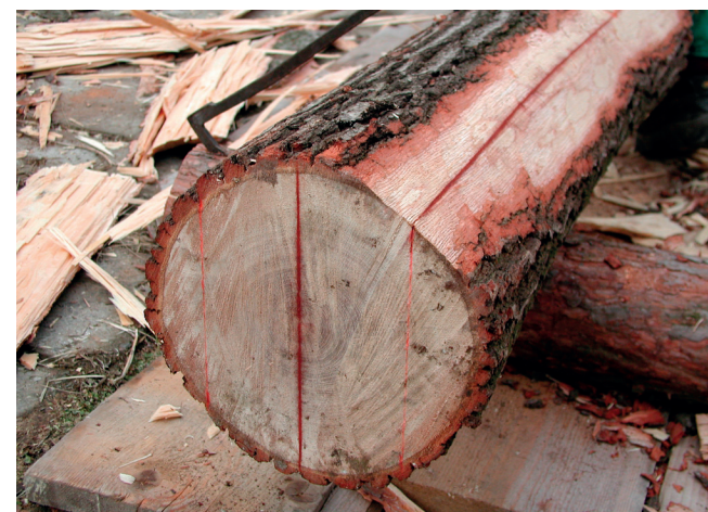
Obr. 5.3.5: Vyznačená linka na kulatině označující místo opracování
