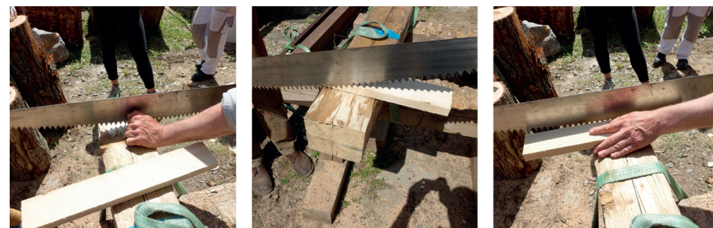
Obr. 5.5.8 Nařezávání horní plochy při příčném řezání
