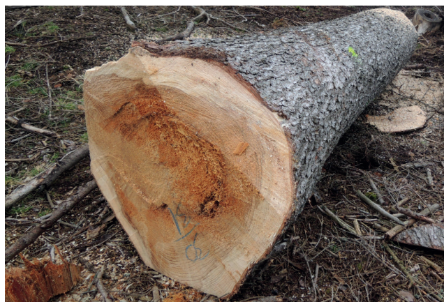
Obr. 3.22: Hniloba na příčném řezu
