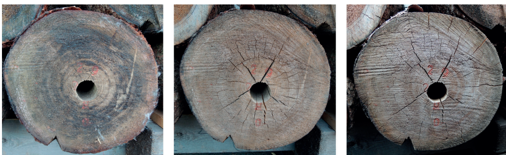
Obr. 4.14: Smrková kulatina s navrtaným středem: A – čelo po těžbě, navrtání a 4měsíční máčení, B – čelo po 1 roce přirozeného vysychání, C – čelo po 2 letech přirozeného vysychání
