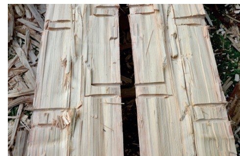
Obr. 5.4.18 Plochy štěpné spáry po rozštípnutí kulatiny
