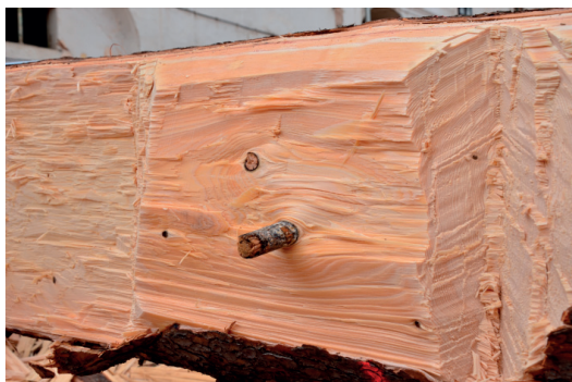
Obr. 3.4: Nabílé suky do 1/3 průřezu (před a po odseknutí při hrubování)
