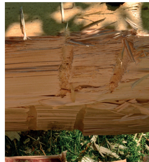
Obr. 5.4.16 Štěpná spára po rozštípnutí kulatiny
