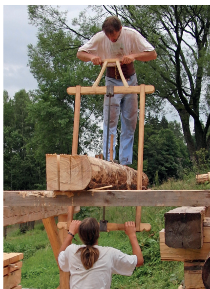
Obr. 5.1.25: Rámová pila pro podélné řezání
