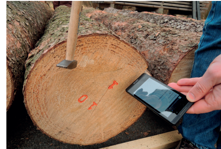
Obr. 3.25: Buzení zvukové vlny pomocí kladívka a analýza pomocí mikrofonu mobilního telefonu
