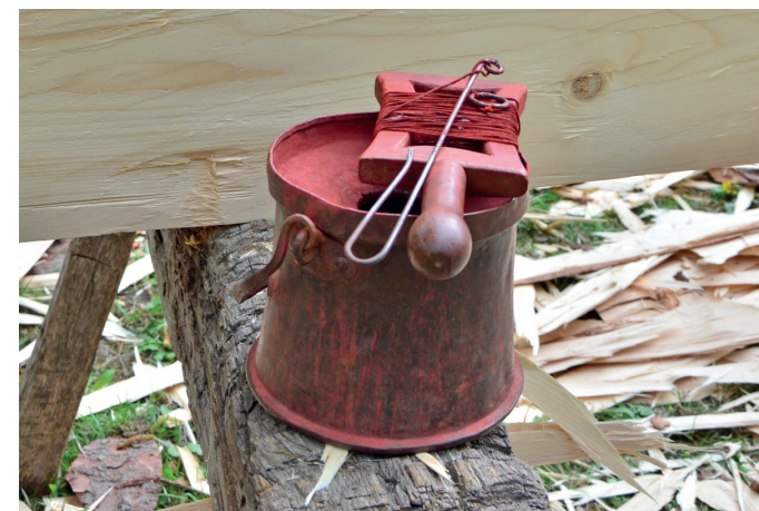
Obr. 5.1.14: Linkovací šňůra za mokra
