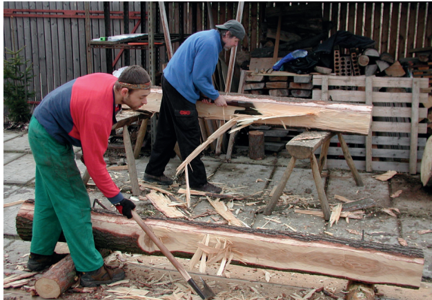
Obr. 5.1.1: Uložení kulatiny na podkladech vpředu a na kozách v pozadí
