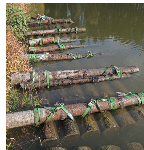
Obr. 4.16: Máčení smrkové kulatiny
