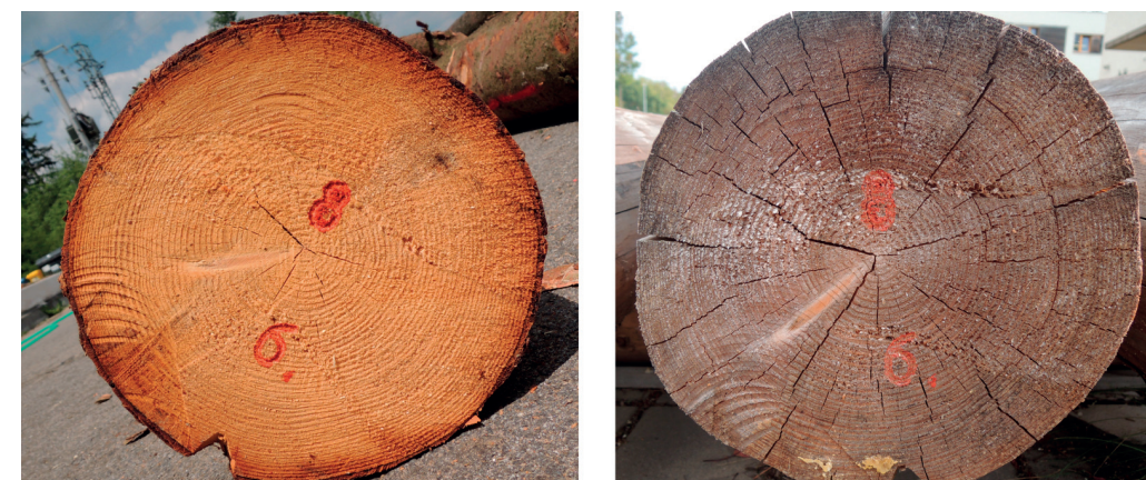
Obr. 4.7: Jarní těžba: A – čelo oloupané kulatiny po kácení, B – čelo oloupané kulatiny po 1. roce přirozeného stárnutí
