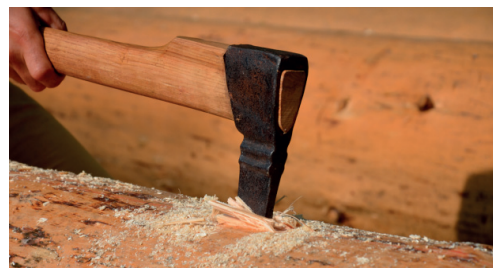
Obr. 5.4.8 Dlabání lůžka pomocí hlavatky
