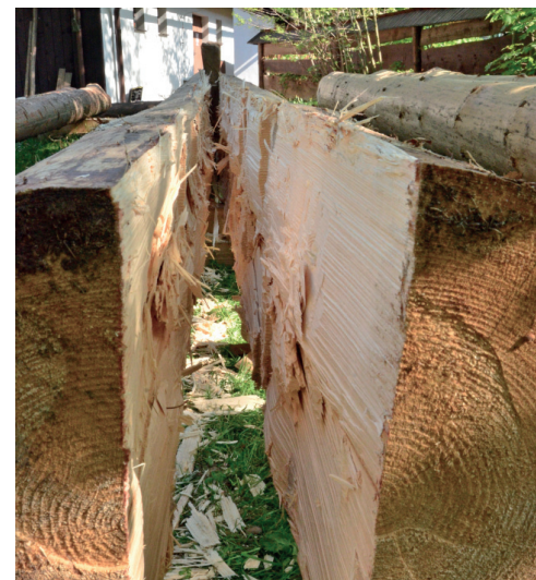
Obr. 5.4.15 Štěpná spára z pohledu na čelo kulatiny, kde se začalo se štípáním
