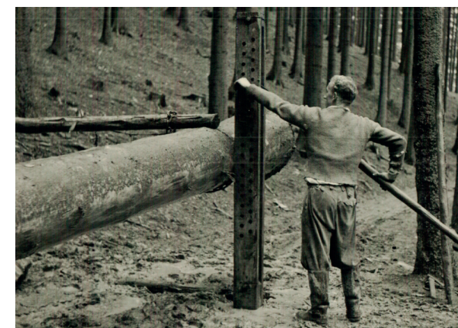
Obr. 5.2.6: Zvedání kmene pomocí pákového heveru (Zahradník, 1955)
