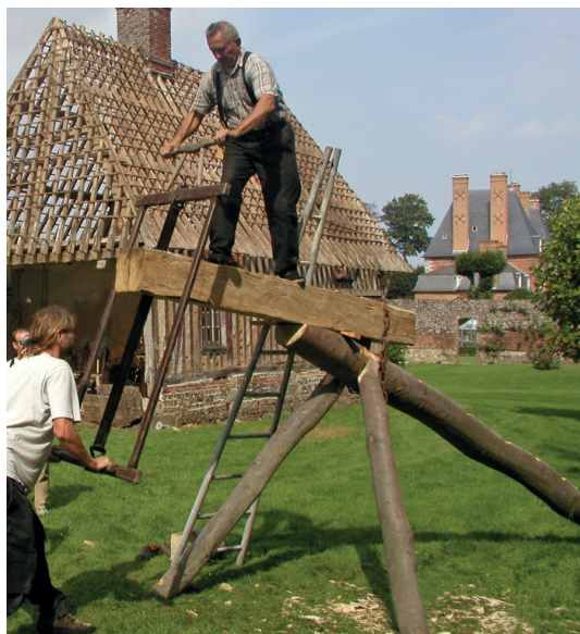
Obr. 5.5.7 Podélné řezání na trojnohé koze
