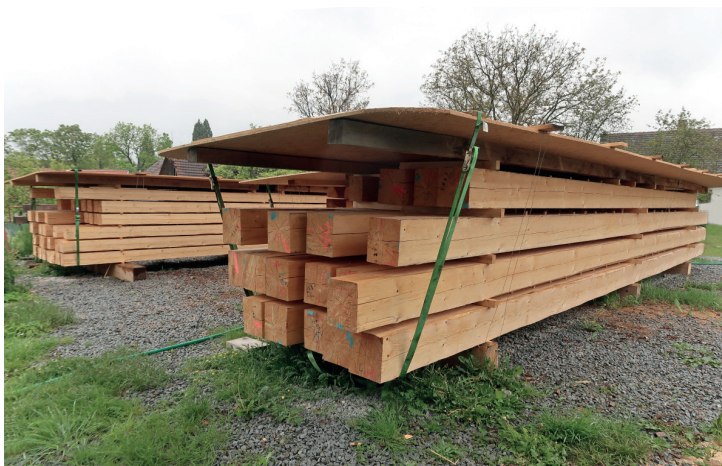
Obr. 6.4: Hráň stropních trámů při přirozeném sušení zastřešená pomocí OSB desek
