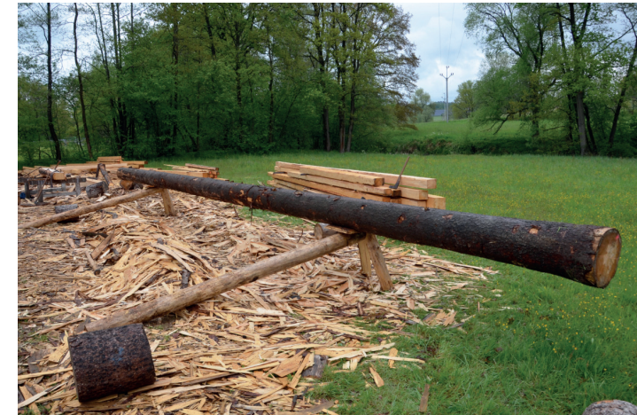
Obr. 5.1.3: Navalovací kozy pro práci ve výšce pasu
