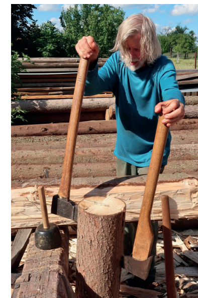
Obr. 5.4.26 Štípání na stojato pomocí dvou hlavatek, které se postupně zasouvají do rozštěpu a páčí
