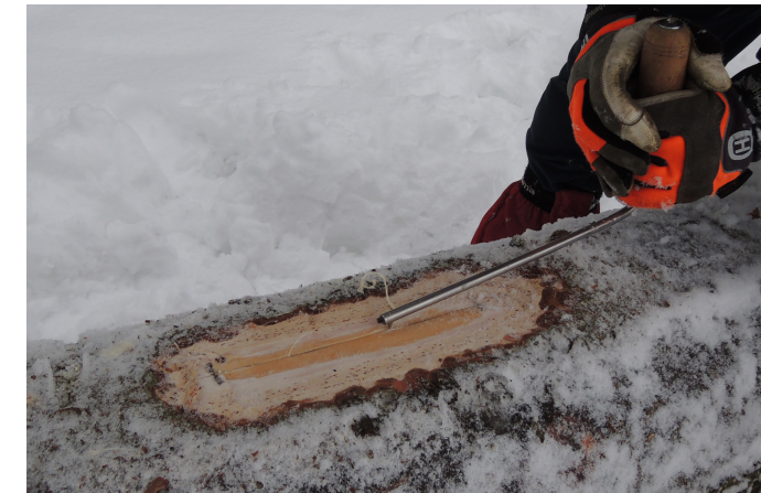
Obr. 3.10: Zjišťování točitosti kmene smrku pomocí črtáku
