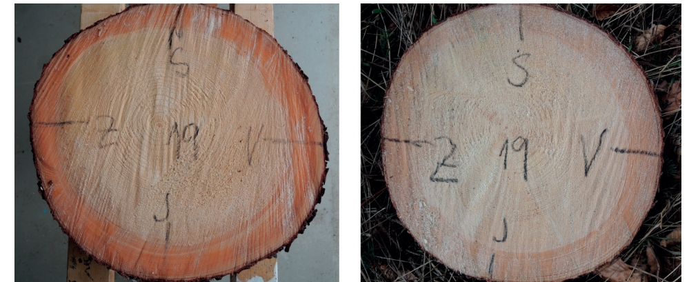
Obr. 4.2: Zimní těžba: A – po kácení, 3. února, vlhkost dřeva (běl 147%, jádro 31%), B – po 1. měsíci ve větvích, 3. března, vlhkost dřeva (běl 147%, jádro 30%)
