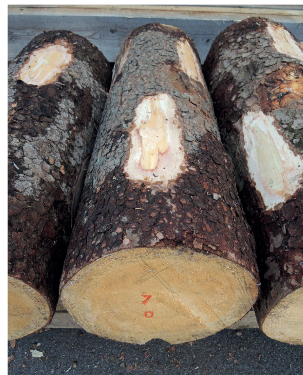
Obr. 4.11: Prokřesání – testovací odstranění kůry v podélně orientovaných pruzích
