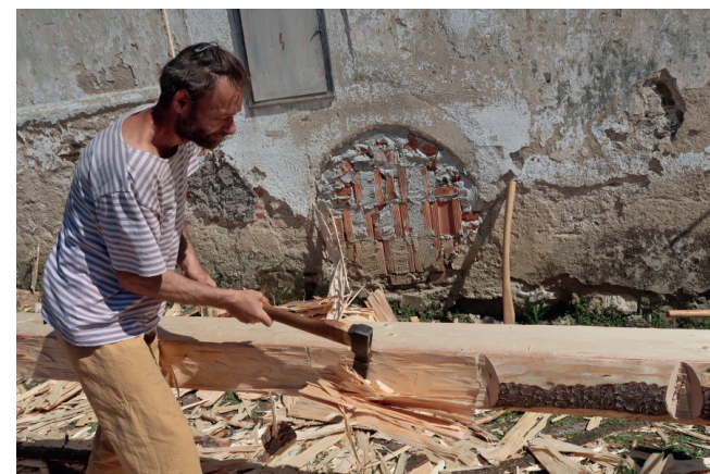
Obr. 5.3.3: Hrubování při běžném postoji, kdy kulatina na kozách je ve výšce pasu
