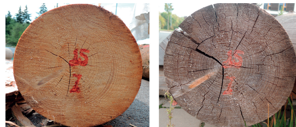
Obr. 4.8: Jarní těžba: A – čelo oloupané kulatiny po kácení, B – čelo oloupané kulatiny po 1. roce přirozeného stárnutí
