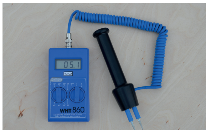
Obr. 6.7: Odporový vlhkoměr s elektrodami o dvou kolících
