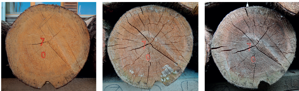
Obr. 4.12: Smrková kulatina bez navrtání středu: A – čelo po těžbě, B – čelo po 1 roce přirozeného vysychání, C – čelo po 2 letech přirozeného vysychání
