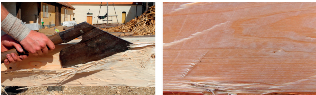
Obr. 5.3.21: Optimální úhel dopadu širočiny při lícování je okolo 30° (k ose kulatiny)
