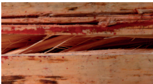
Obr. 5.4.11 Dřevní vlákna u točitého dřeva probíhající přes štěpnou spáru
