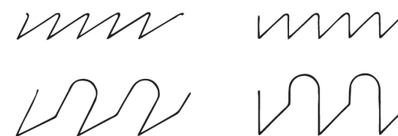
Obr. 5.1.27: Tvary zubů rozmítačky (trojúhelníkové a vlčí)
